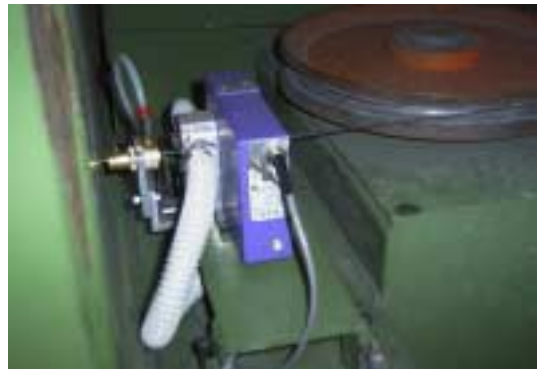
Fig.7: Utilisation d'une jauge ALS13XY équipée avec la nouvelle protection "auto-nettoyante"
