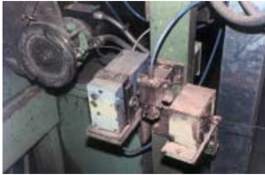
Fig.5: Utilisation d'une jauge ALS12XY sur une tréfileuse à sec.
