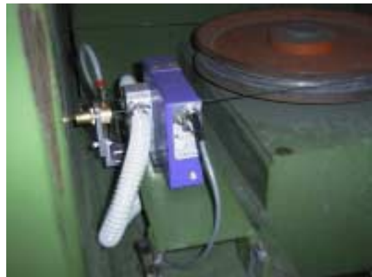
Fig. 7: Applicazione del calibro ALS13XY completato con la nuova protezione auto-pulente.
