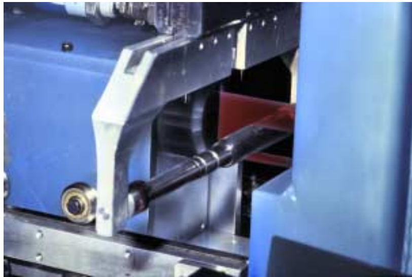
Fig. 4: Un albero innesto marce viene controllato in una macchina asservita da portale. Non è richiesta nessuna meccanica addizionale e non c'è bisogno di rallentare o fermare il portale.
