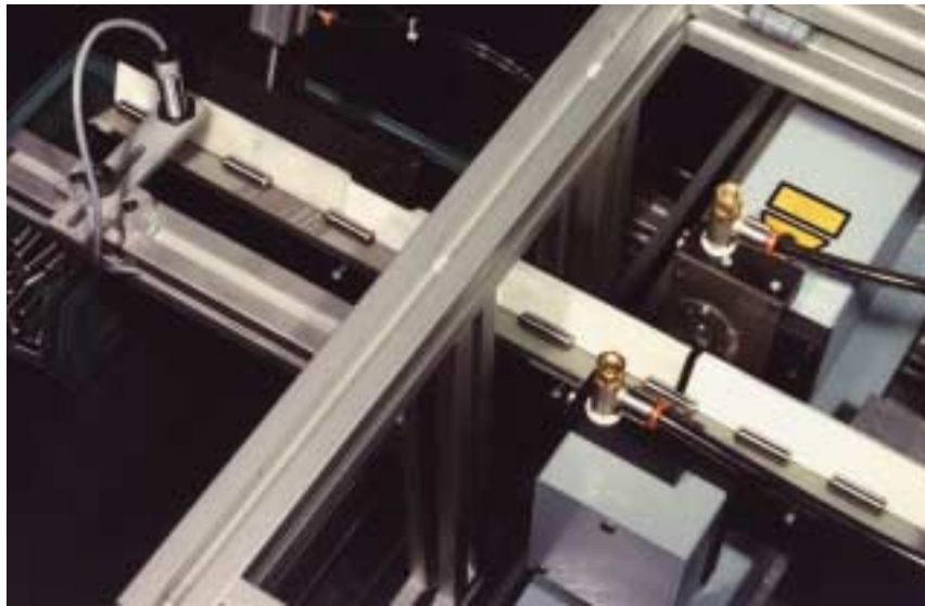
Fig. 6: La misura in passata del diametro esterno di spinotti è facile ed accurata: è così possibile regolare la rettifica e selezionare i pezzi.
