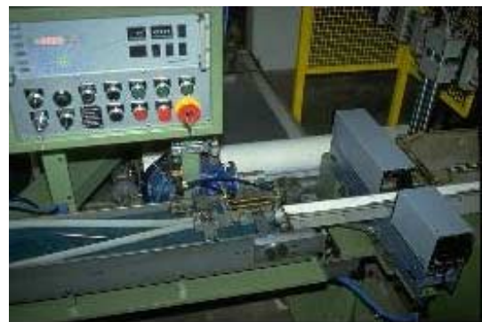
Fig. 3: Un alberino per motore elettrico viene misurato dopo la lavorazione "a tuffo" in rettifica. Durante Un singolo passaggio vengono misurati cinque diversi diametri, ognuno con la precisione di \pm 1 \mu\text{m} .
