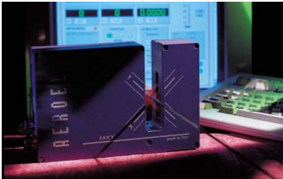
Fig. 1 : Un recentissimo calibro a fasci incrociati per la misura di fili trafilati. Rispetto ad un suo "antenato" del 1987 è caratterizzato da una precisione 10 volte più elevata, un volume ridotto di 29 volte ed un costo 3 volte inferiore
