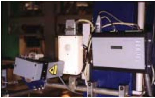
Fig. 8: Misura del diametro (0,065 mm) di filo smaltato.
