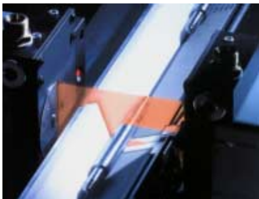
Fig. 5: Misura multidiametro in passata, all'uscita di una rettifiche senza centri
