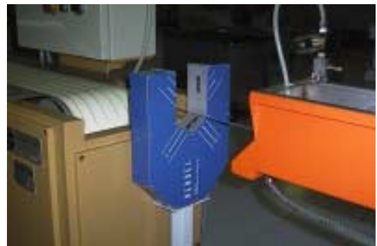
Fig. 7: Controllo di tubo in plastica estruso
